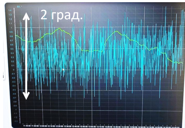
Сравнение крена судна на ЛСП и при классической морской гравиметрии
