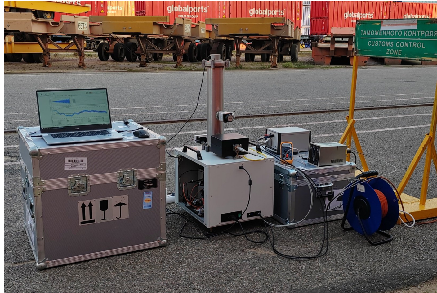
Гравиметр ГАБЛ-ПМ и сервисное оборудование на причале (Санкт-Петербург, ПетроЛесПорт)
