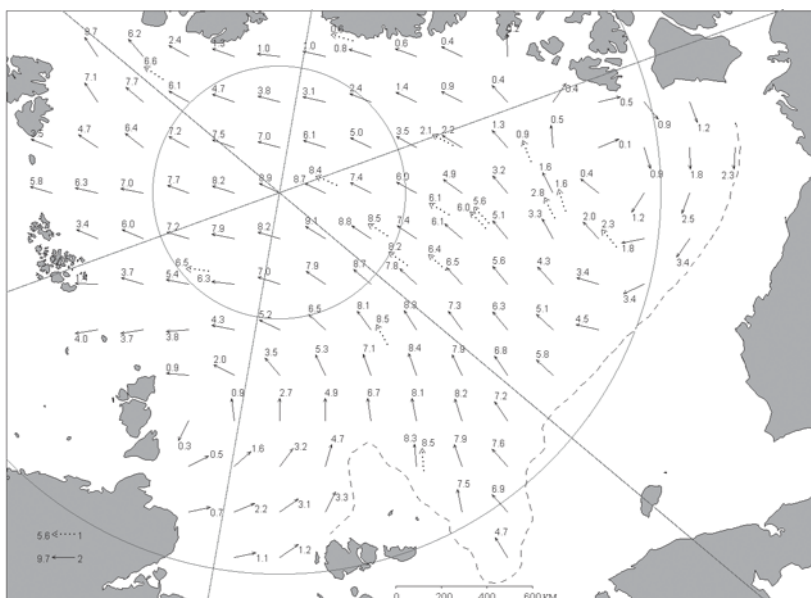
Рис. 2.27. Поле результирующего дрейфа льда за октябрь 2007 г. (1 — направление и скорость дрейфа буев (км/сут); 2 — рассчитанные характеристики дрейфа льда)
