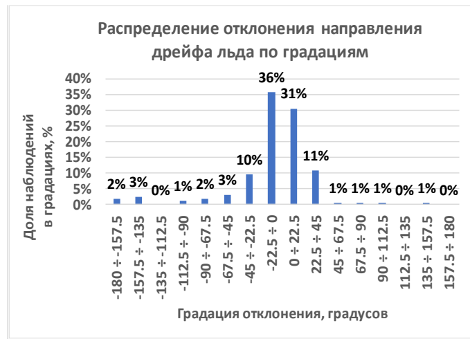
Роза дрейфа льда в рабочей зоне Ice Vision в порту Сабетта за периоды сравнительных измерений
